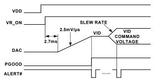
FIGURE 7. VR1SOFT-START WAVEFORMS
